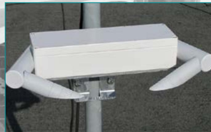
El equipo básico para el punto de control consta de un **sensor VSK** fijado en un mástil, con armario de control y equipo de comunicaciones integrado, todo ello a precios muy competitivos.
