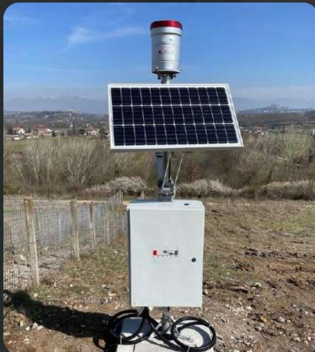
G.Re.T.A. es la solución más eficaz e innovadora para el **Monitoreo Geoeléctrico** permanente de las condiciones de grandes secciones de suelo.
